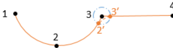
图 11-40 提前到达交融半径 Move arc-Move L 运行轨迹示例
