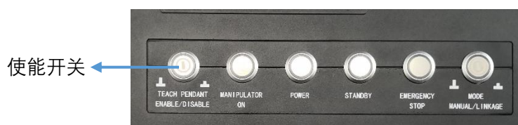
图 7-6 示教器使能开关位置
