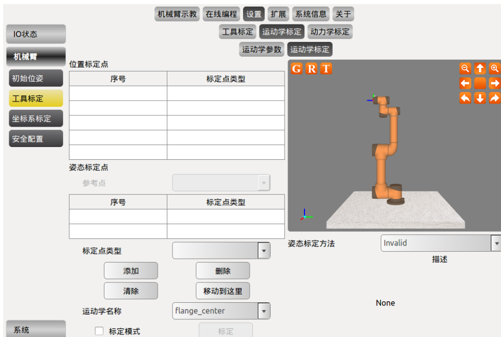
图 10-28 运动学工具标定
