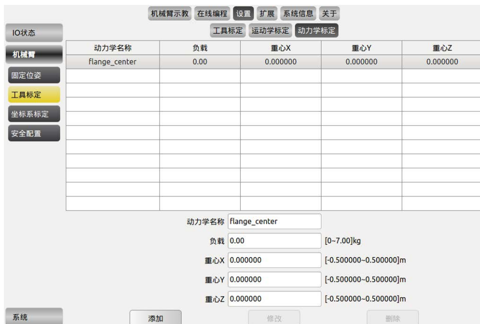
图 10-36 工具动力学标定
