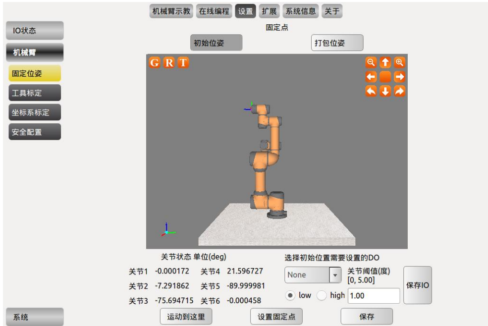
图 10-27 机器人初始位姿设置
